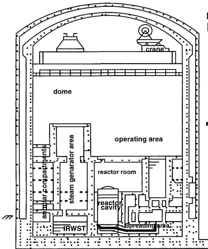
Fig. 1 : EPR Containment Section : 0° - 255°
