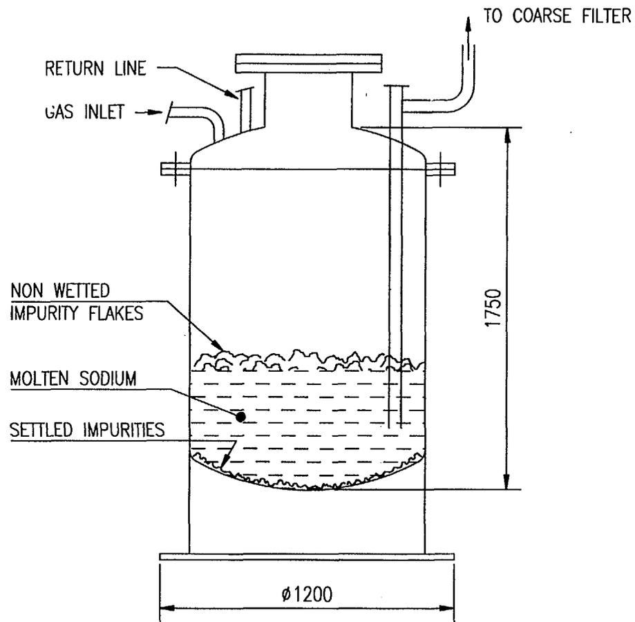
Fig. 1 MELTER TANK
