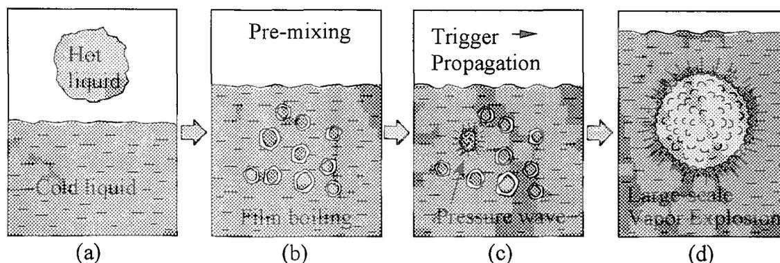
Fig. 1 Thermal detonation model<sup>[1]</sup>
