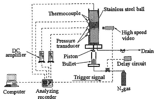
Fig. 2 Experimental apparatus
