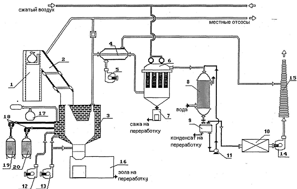
Рис. 2. Установка сжигания ТГРО и ЖГРО "Факел":
