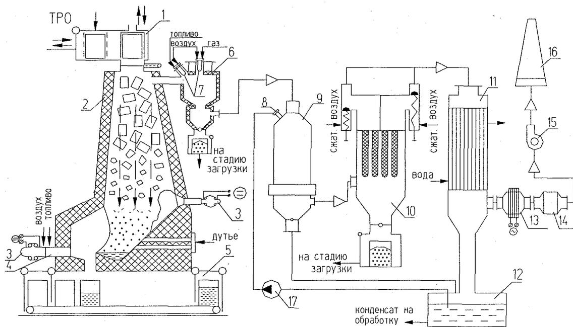
**Рис. 5.** Технологическая схема опытной установки переработки ТРО.
