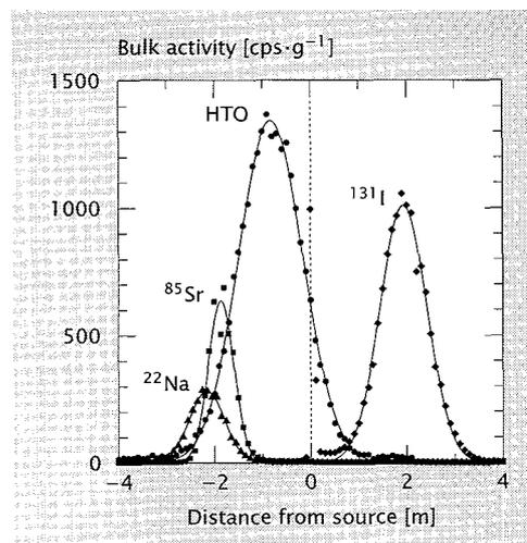
**Figure 6** Distribution profiles after electromigration of  $^{85}\text{Sr}$  ( $72 \text{ V}\cdot\text{m}^{-1}$ , 71 hrs),  $^{22}\text{Na}$  ( $84 \text{ V}\cdot\text{m}^{-1}$ , 20 hrs), HTO ( $79 \text{ V}\cdot\text{m}^{-1}$ , 20 hrs),  $^{131}\text{I}$  ( $81 \text{ V}\cdot\text{m}^{-1}$ , 20 hrs).
