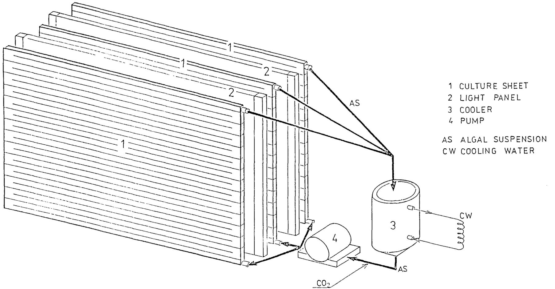
Fig.3 : SCHEME OF A MODULAR PHOTOBIOREACTOR WITH ARTIFICIAL IRRADIATION
