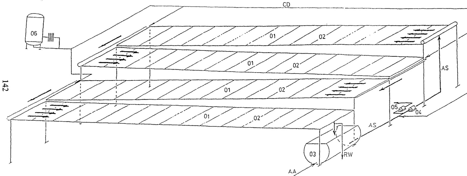
Fig. 2 : SCHEME OF AN OUTDOOR SLOPED BIOREACTOR
