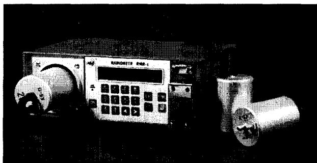
Fot. 2. Radiometr RMR1 z komorami Lucasa.
