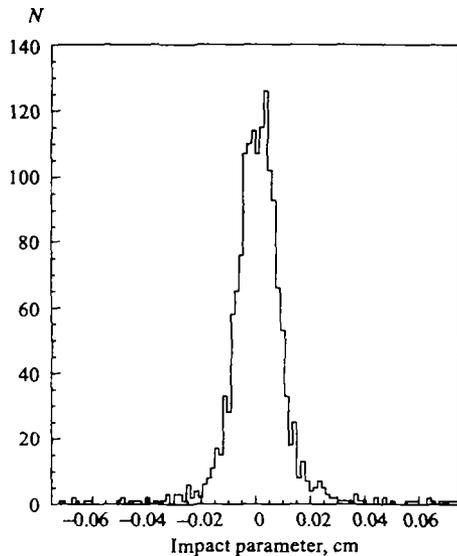
Fig. 3. Impact parameter distribution in the «silicon-only» configuration
