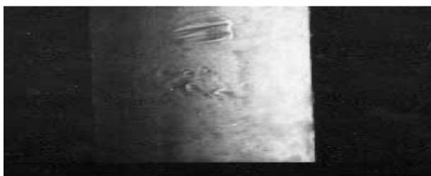
图8 外协钨丝 SEM 图片 ( 23.6\ \mu\text{m} )
