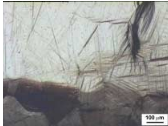
Fig. 2b. Capa de hidruro y fase \gamma con microestructura de agujas. Microscopía óptica. Sección transversal. Método HM \gamma .
