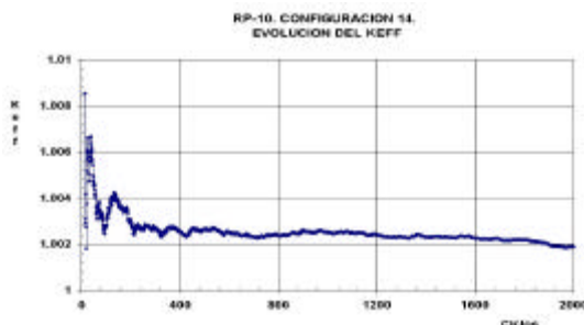
Figura 3. Variación del valor del Keff como función del número de ciclos, para la simulación de la posición experimental de crítico de la Configuración 14 del RP-10
