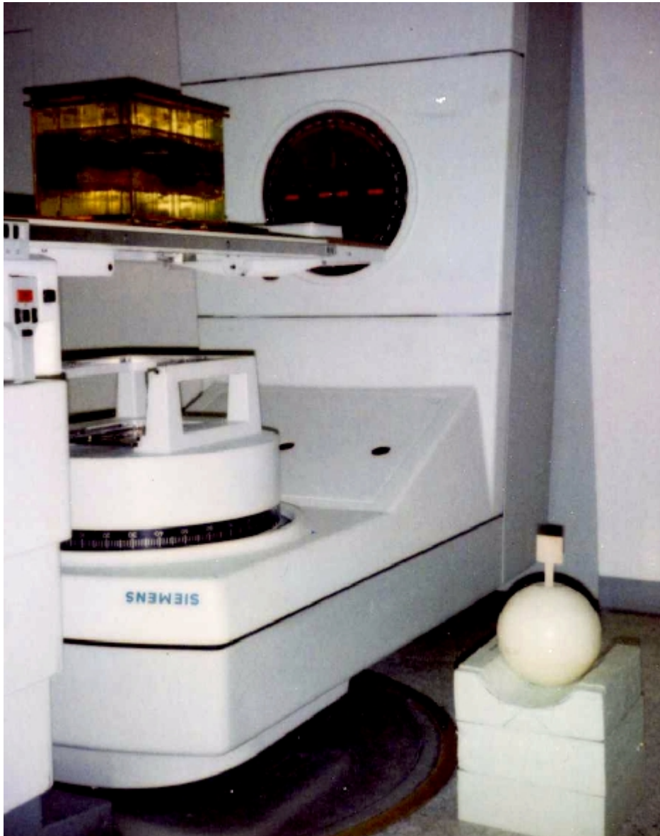
Figura 2.- Medida de la dosis equivalente con la esfera de parafina con los TLDs. Como ha sido demostrado por Vega-Carrillo y Becerra-Ferreiro (2001) una esfera de material hidrogenado de 25.4 cm de diámetro con un detector de neutrones térmicos en su centro tiene una respuesta similar a los remmeters comerciales. Así se construyó un dosímetro pasivo esférico con 25.4 cm de diámetro, el dosímetro se fabrica con parafina como moderador y con pares de TLDs en su centro. La respuesta de este dispositivo se muestra en la figura 3.
