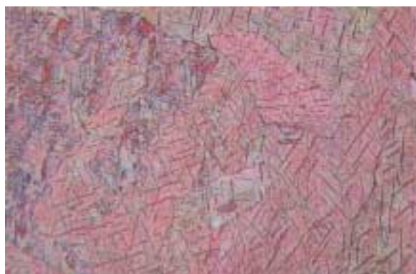
Fig. 1. Probeta hidrurada, antes del tratamiento térmico de difusión de los hidruros. Se observa la capa de hidruros masivos (original x 100).
