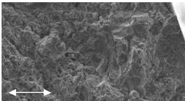
Figura 3: Sector de la superficie de fractura del material A, ensayado bajo carga catódica donde se observan varios mecanismos de fractura.
