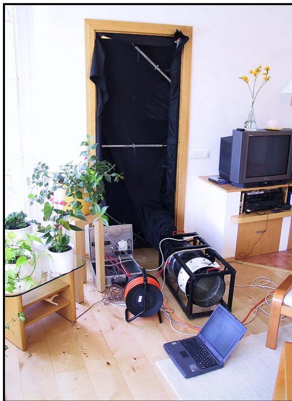
Fig1. The blower door technique.
