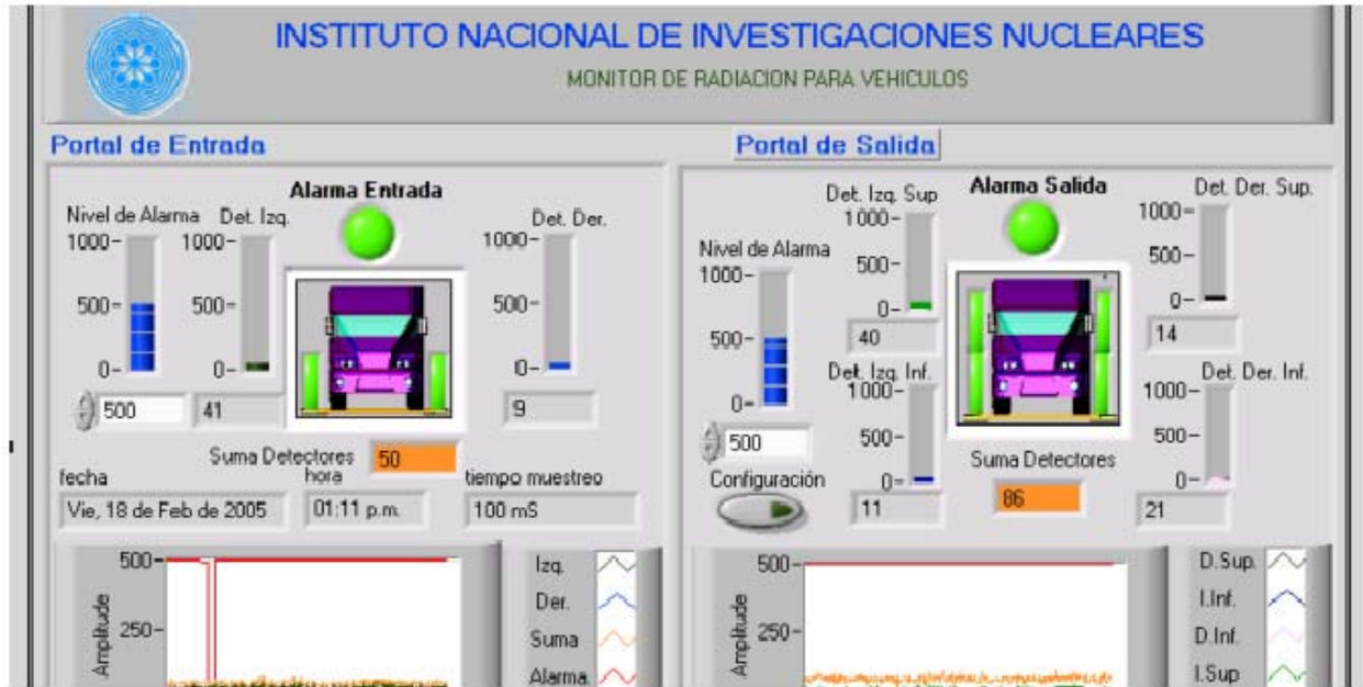
Figura 2. Interfaz hombre máquina del sistema de monitoreo de radiación gamma de vehículos tipo portal.
