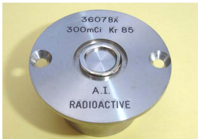
Figura 2. Fuente radiactiva sellada de ^{85}\text{Kr} con actividad intermedia
