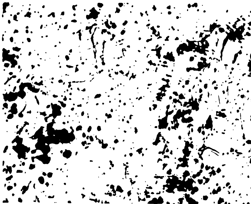
Fig. 15 - Alliage U - C fondu à l'arc (5,7 %C en poids) Echantillon type B - Conservation sous vide (2 mois) - Corrosion superficielle (taches noires).
