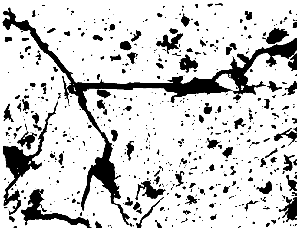
Fig. 1 - a) Alliages U - C fondu "B.E." (4,92 %C en poids) Corrosion à l'air ambiant (80 jours) - Sans attaque chimique - Réseau de microfissures (lignes brisées fines) et macrofissures (traits noirs, épais) - Précipités d' UC_2 (lignes paral- lèle claires) - Excroissances (petites tâches sombres).
