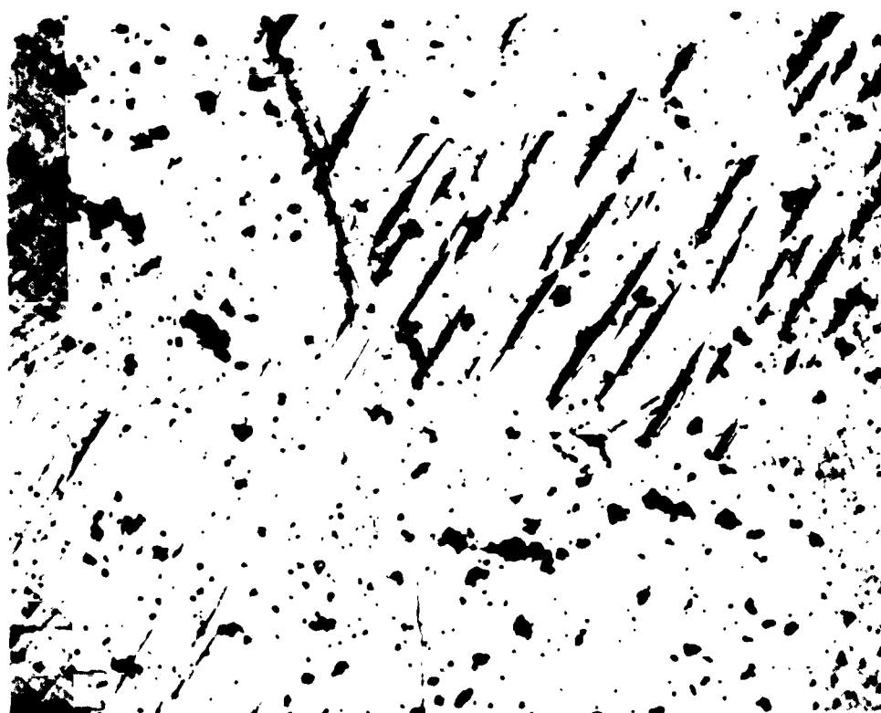
Fig. 13 - Alliage U - C fondu "B.E." (5,1 %C en poids) Echantillon type B - Conservation sous vide (2 mois) - Corrosion superficielle et piqûres (taches noires) - Précipitations d'UC 2 (traits parallèles).
