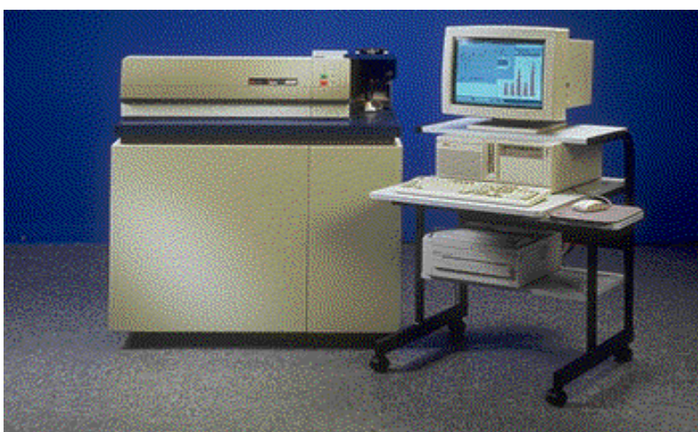
FIGURA 3.1 – Espectrômetro de massa ELAN 6000.
