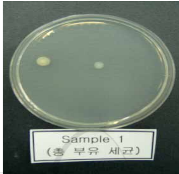
그림 13. 자외선 공기살균장치 설치 후 일반세균 배양사진 (Pre-Filter 통과 후 지점)
