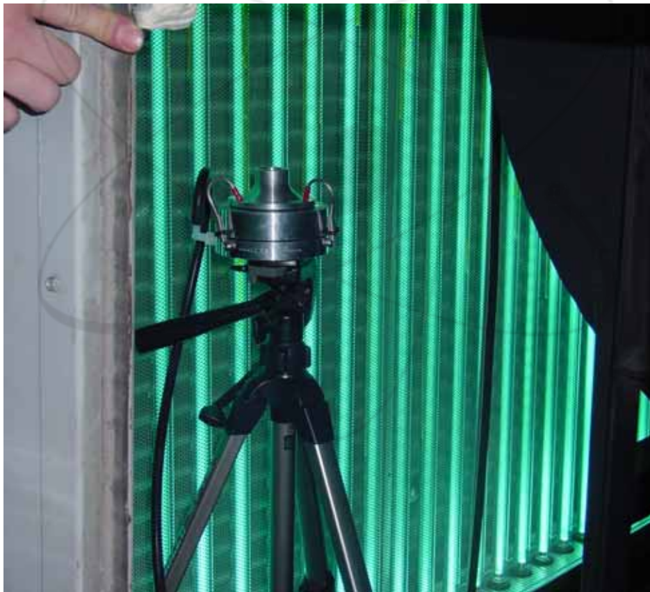
그림 7. 자외선 램프운전 및 세균포집기 설치 상태
