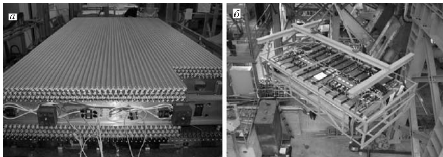
Рис. 1. a ) Камера MDT (BMS1C08) на сборочном столе производственного участка ЛЯП ОИЯИ; б ) момент опускания MDT/RPC-модуля в шахту экспериментальной установки
