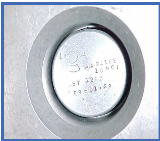
Fig.2 Detalle del blindaje de la sonda
