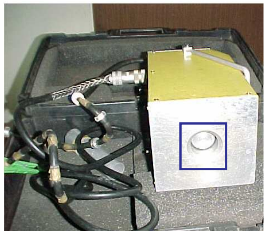
Fig.2 Detalle del blindaje de la sonda
