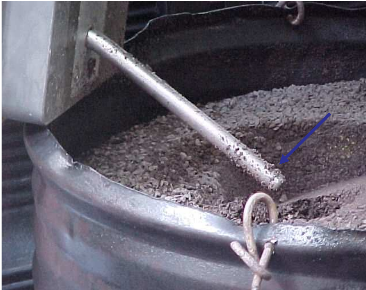
Fig. 5 Detalle de la varilla, indicando ubicación de fuente gamma
