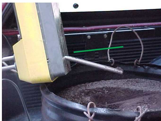
Fig. 4 Equipo con la varilla doblada
