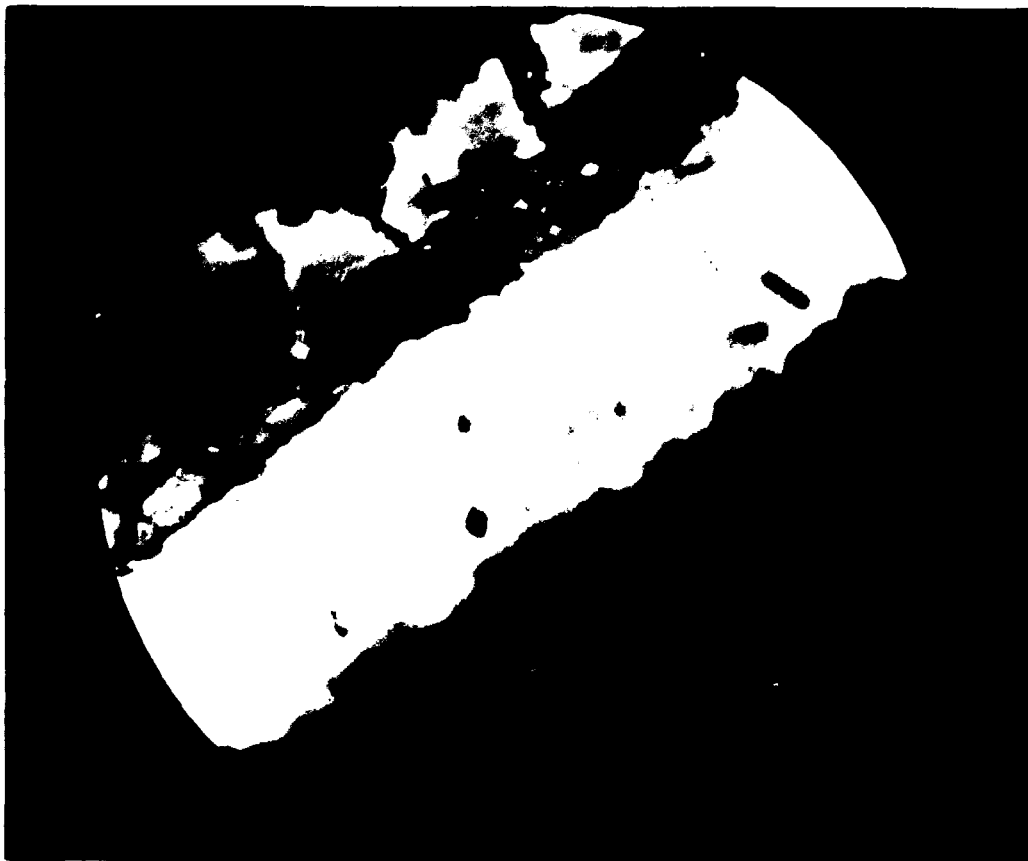
Fig. 13. — Grossissement 2500. Structure analogue à celle de la fig. 12, après une oxydation atmosphérique de 8 jours à 20°C.
