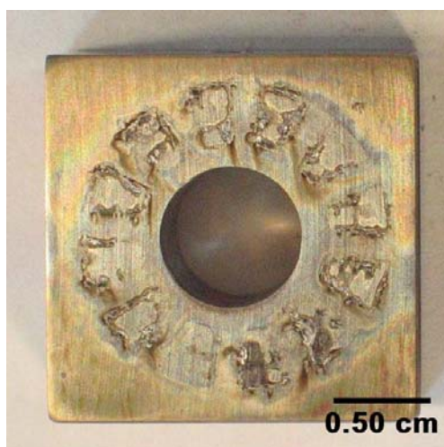
Figura 6. Probeta PCA de Aleación C-22 que sufrió corrosión en rendijas durante una curva de polarización potenciodinámica en NaCl 1M, a pH 6 y 90°C.
