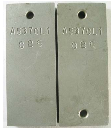
FIGURA 3. a) Probeta electroquímica. Dimensiones: \varnothing : 15 mm, Altura: 50 mm, área \sim 27 \text{ cm}^2 . b) cupones de pérdida de peso. Izquierda: en la solución. Derecha: en la fase vapor. Dimensiones: 5.00 x 2.00 x 0.64 cm; Peso \sim 49 \text{ g} ; Área \sim 30 \text{ cm}^2 .
