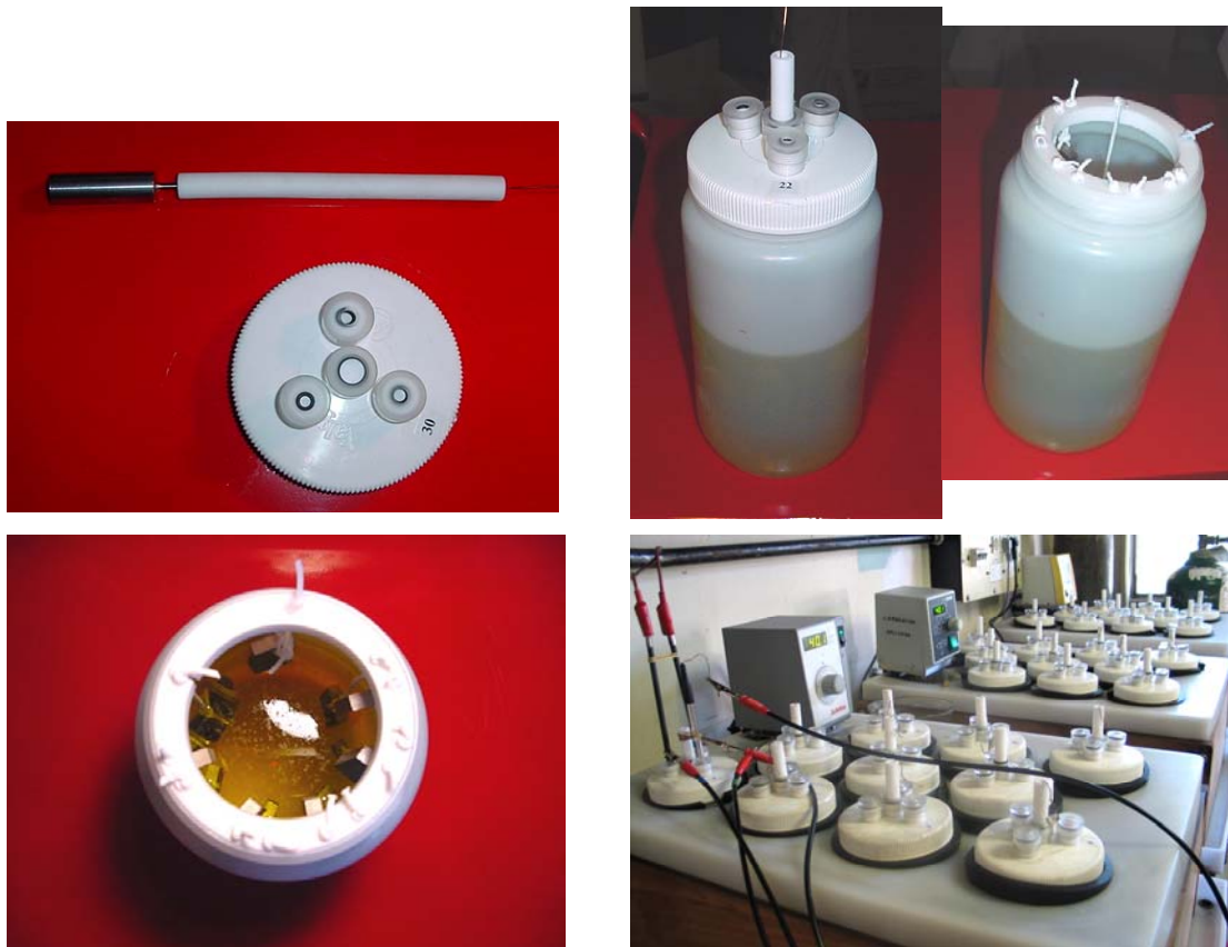
FIGURA 4. Fotografías del arreglo experimental de los ensayos de inmersión a largo plazo. Arriba-izq.: probeta electroquímica y tapa de la celda adaptada para las medidas electroquímicas.
