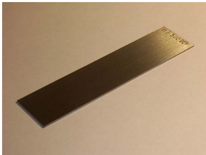
Miniplaca ( 100 x 25 x 1 mm 3 ) monolítica de U-7Mo con plaquedo de Zry-4. El núcleo tiene un espesor de 0,5 mm y una densidad de 16 grU/cm 3 .
