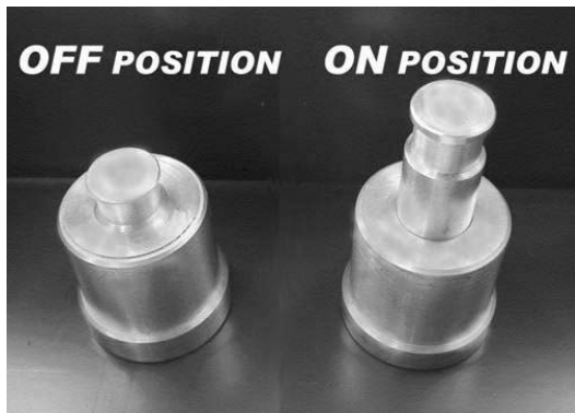
Fig. 5 ENEA Piston Radon Dosimeter (PRD)
