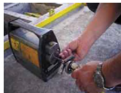
Dispositivo típico de blindaje de iridio 192. Fotografía: Comisión Chilena de Energía Nuclear
