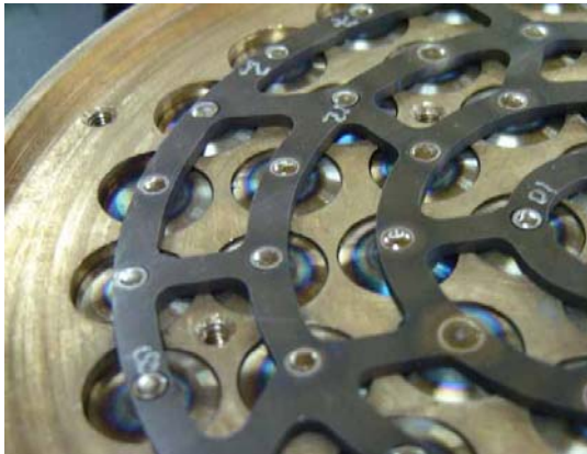
Figura 1: Prototipo de soldadura de grilla para el EC CARA.
