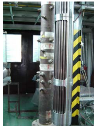
Figura 12: EC CARA para Atucha en posición - verificación de tomas de presión.
