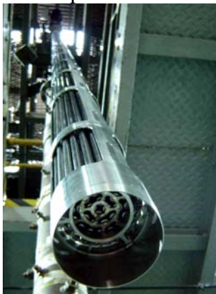
Figura 13: Vista inferior del EC CARA para Atucha en el CBP del CAC.
