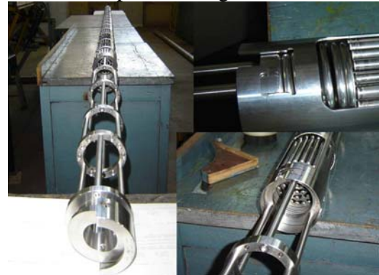
Figura 10: Varillaje, extremo de sujeción y resorte del sistema de ensamble CARA.
