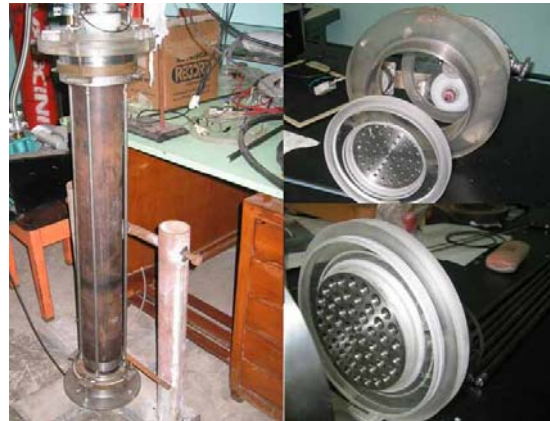
Figura 2: Estación de soldadura y cabezales prototipo.
