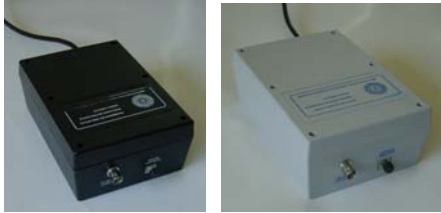
Fig. 2 Nuevo Modulador y demodulador de Señales meteorológicas por fibra óptica.
