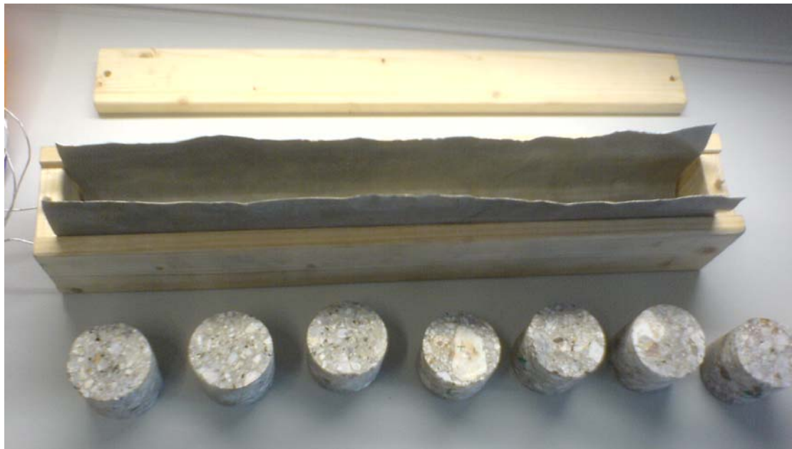
Abb. 4 Holzbox mit Cd-Auskleidung und Betonblöcke
