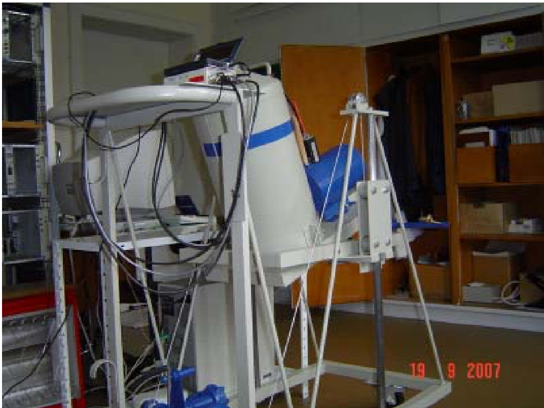
Sl. 4. Pokretni poluprovodnički Ge detektor sa olovnim kolimatorom usmerenim prema kutiji sa standardnim laboratorijskih izvorima gama zračenja poznatog intenziteta
