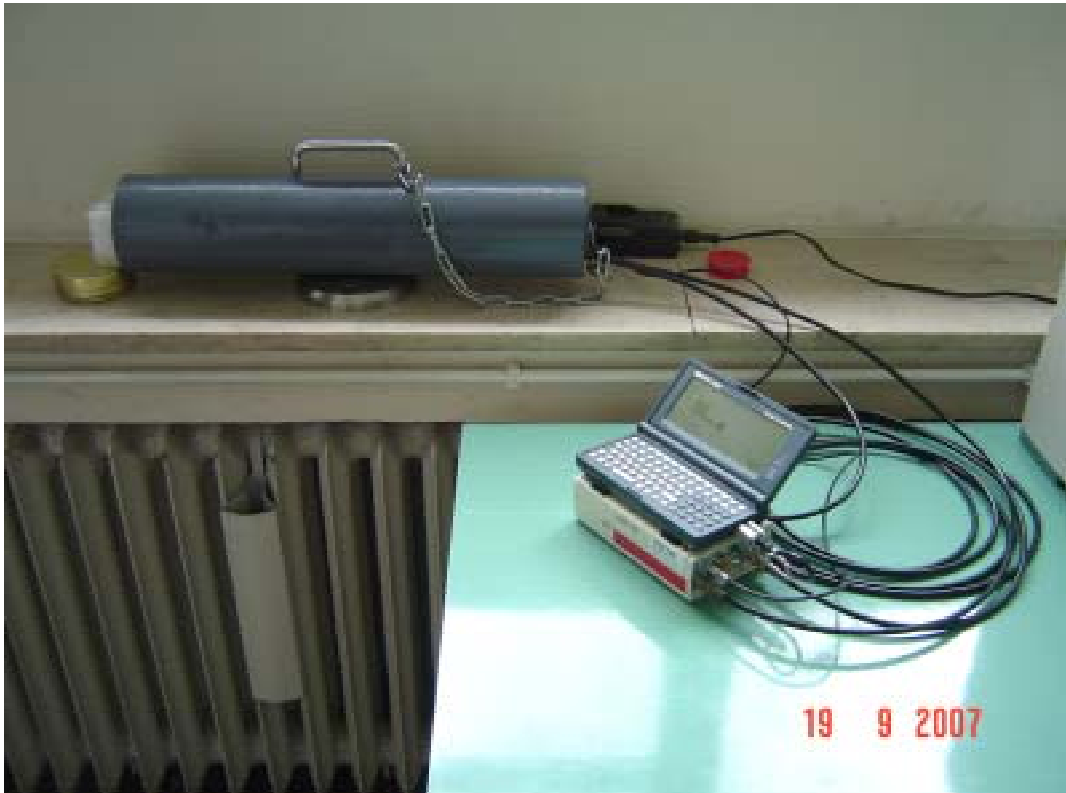
Sl. 6. Scintilacioni detektor tipa NaI, dimenzija 3.8x3.8 cm 2 u kolimatoru od olova debljine 1.5 cm
