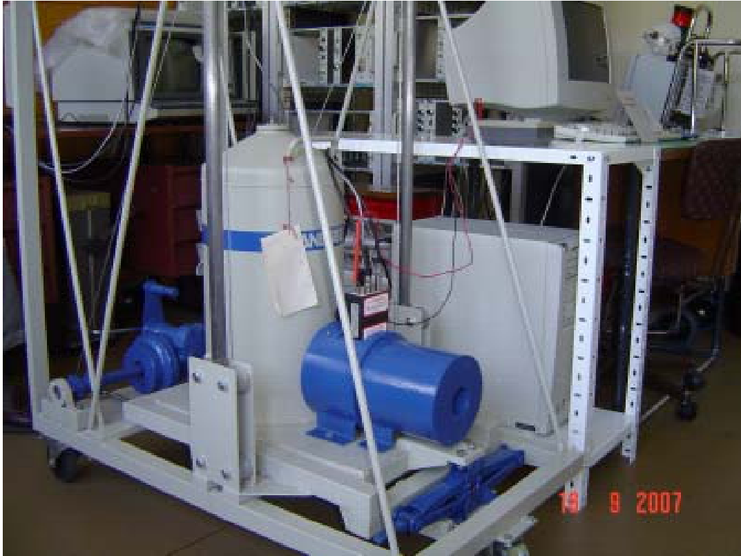
Sl. 3. Pokretni poluprovodnički Ge detektor (mobGe) sa olovnim kolimatorom
