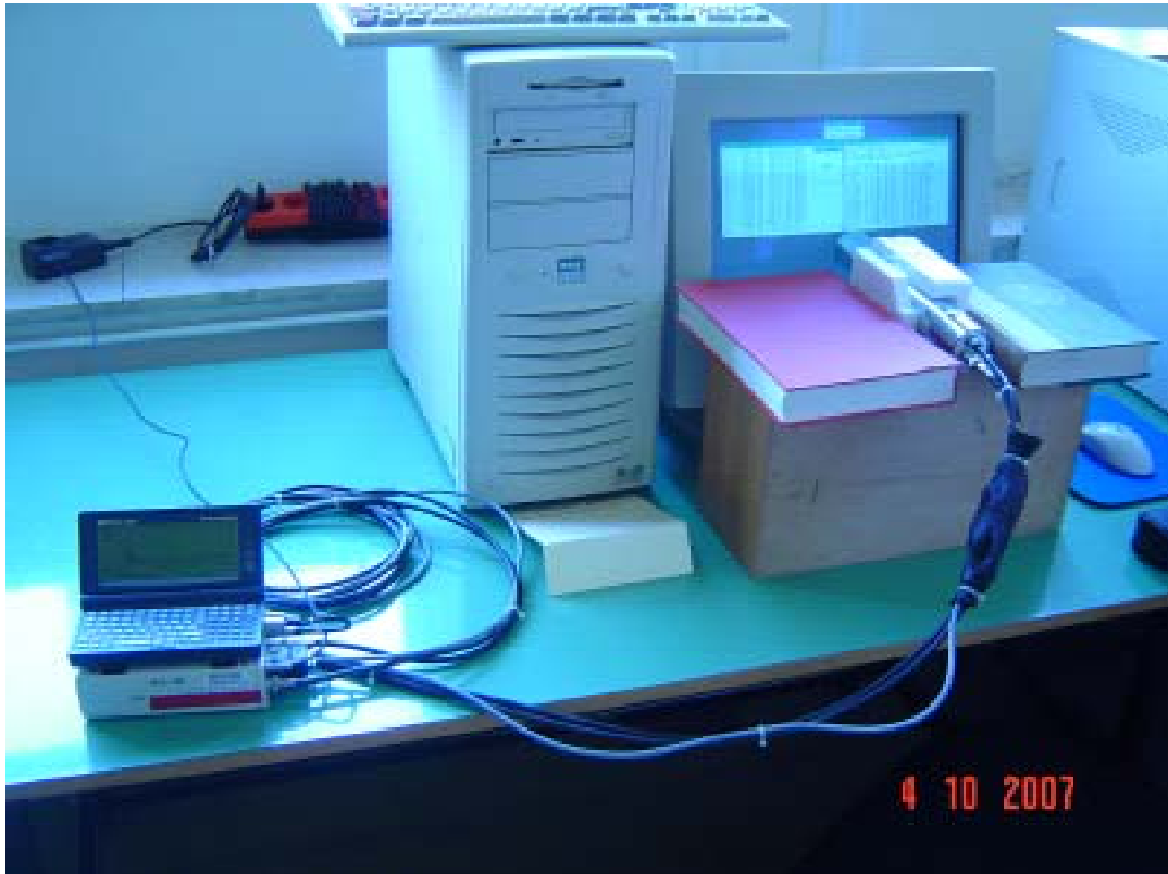
Sl. 7. Scintilacioni detektor tipa NaI, dimenzija 2.5 \times 0.1 \text{ cm}^2 za merenje energetskog spektra X zračenja
