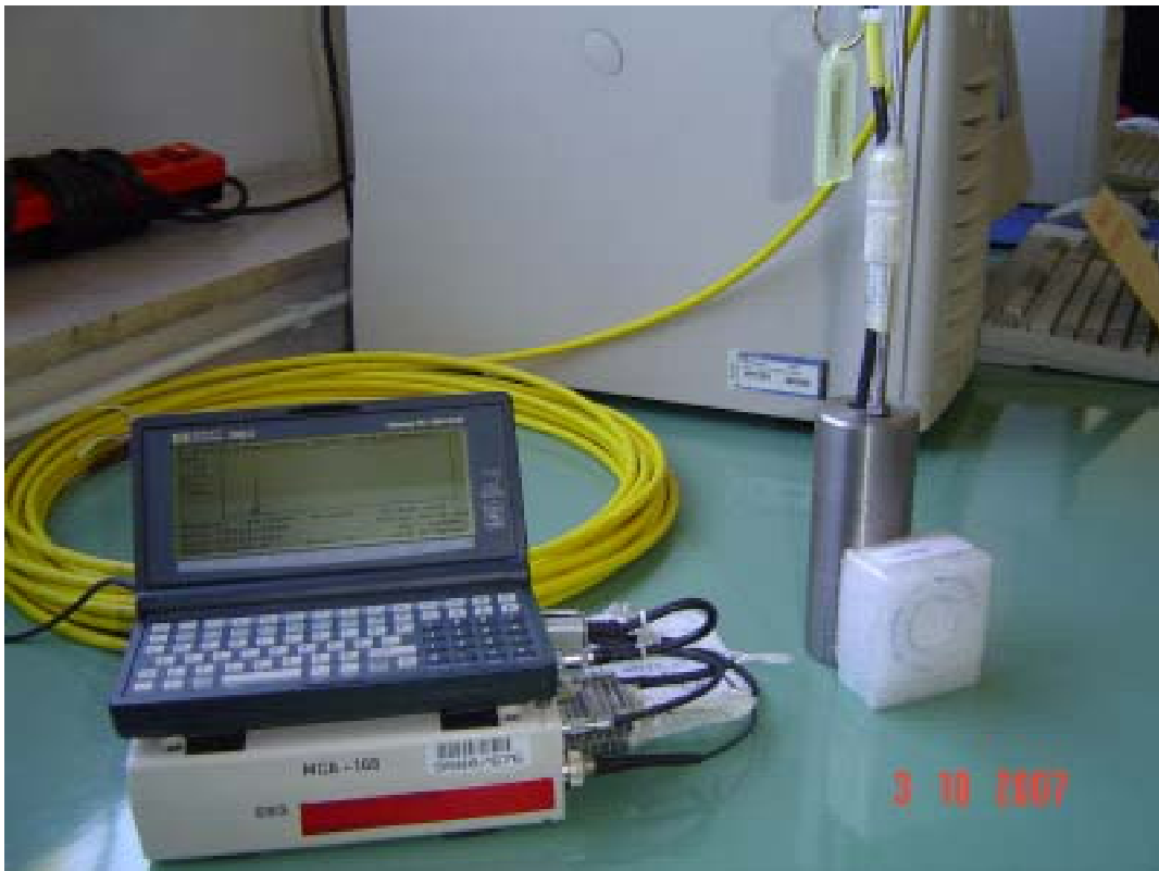
Sl. 5. Poluprovodnički detektor SDP310/Z/05 sa kristalom CdZnTe 5 mm 3 u kolimatoru od folframa sa usmerenom šupljinom prema izvoru gama zračenja
