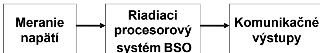
Obr. 6 Bloková štruktúra obvodov sieťovej ochrany
