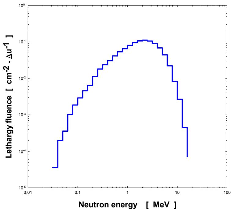
Figure 3.-  $^{252}\text{Cf}$  neutron lethargy spectrum
