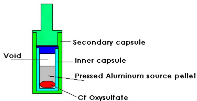
Figure 2.- Cf-252 encapsulation.
