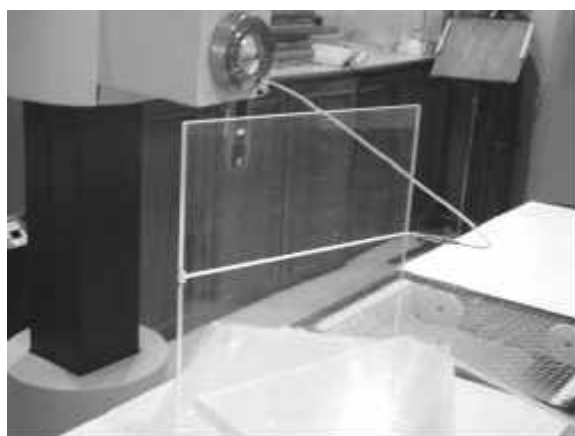
Figura 6-3. Placa de acrílico construída especialmente para servir de suporte da fonte de radiação através de um cateter endobronquial durante as irradiações.
