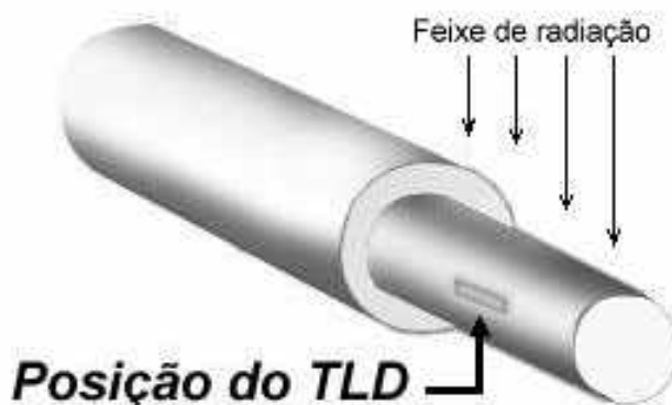
Figura 6-4. Suporte para irradiação dos dosímetros termoluminescentes em forma de câmara de ionização feito de acrílico, com um furo nas dimensões do dosímetro termoluminescente tipo pastilha, para acomodar os TLDs durante a irradiação.
