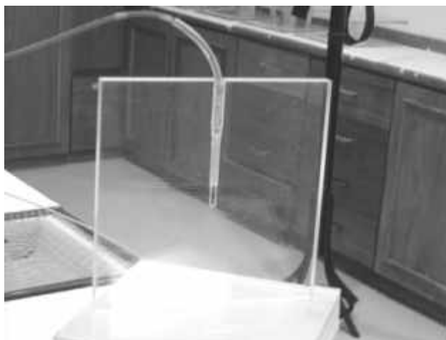
Figura 6-2. Placa de acrílico construída especialmente para fixar a câmara de ionização durante as irradiações.
