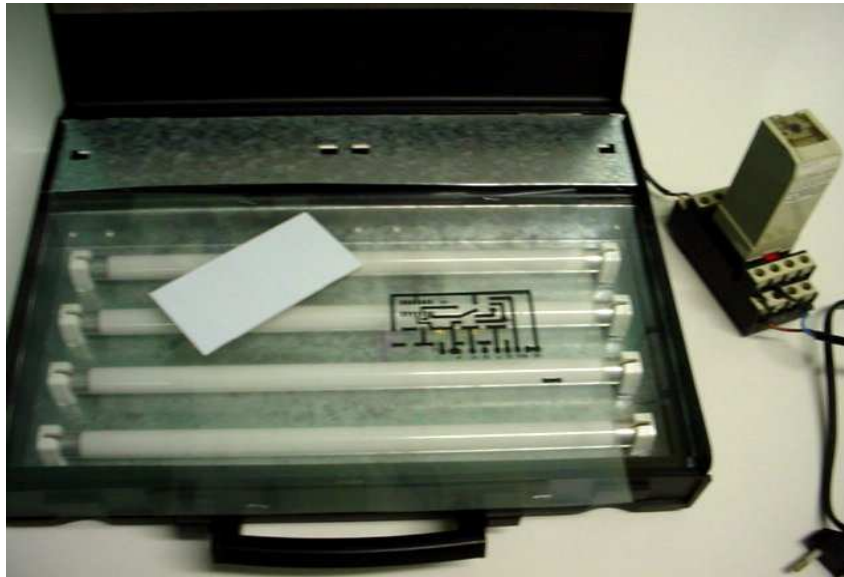
Figure 8 : Insoleuse avec 4 tubes à UV
