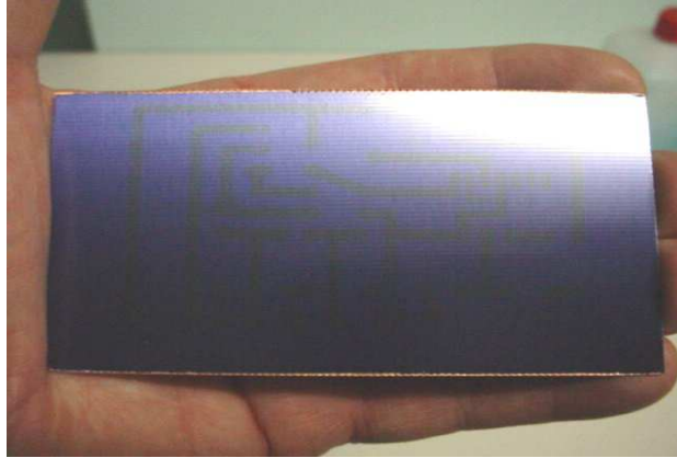
Figure 10 : Apparition du dessin après l'insolation
