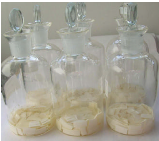
FIGURA 8. Embalagens do tipo COEX picadas após a irradiação e preparadas para extração do clorpirifós em acetonitrila.
