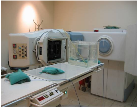
الشكل (3): جهاز معالجة بالكوبالت-60 من نموذج TIRADE_80 INVAP
