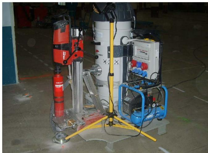
Figure 9: Complete DD200 for dry core drilling
