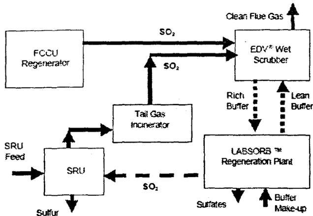
FIG. 5. LABSORB™ TREATING FCCU REGENERATOR GAS PLUS SRU GAS
