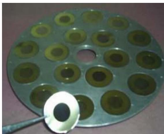
Figura 12. Arandelas com filmes de Collodion metalizadas com ouro, onde são depositadas as alíquotas das soluções radioativas.
