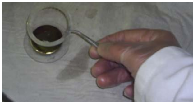
Figura 13. Foto da colocação de um absorvedor de Collodion sobre uma fonte de ^{201}\text{Tl} .
