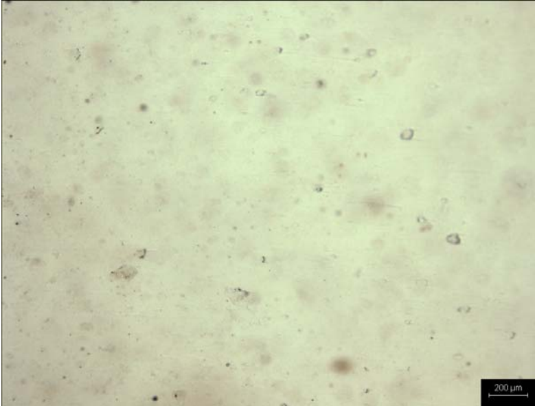
Figura 4 – Micrografia da amostra de CBM após exposição UV durante 120 horas.
