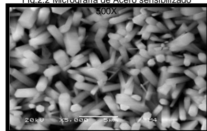
Fig.2.2 Micrografía de Acero sensibilizado
