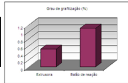
Figura 2: resultados de índ. de carbonila (CI) e grau de graftização obtidos por análise de infravermelho
