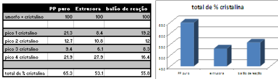
Figura 1B: resultados de percentual cristalino das amostras geradas a partir de difração de raios-x
