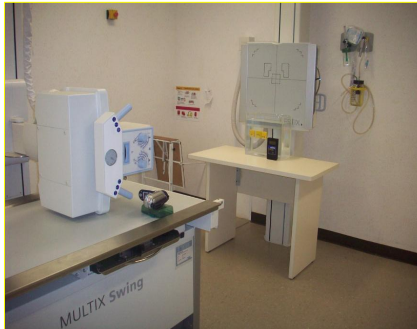
Fig. 3. Irradiación del fantoma
