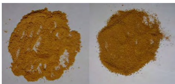
Figura 1. Pigmento de Ferro, calcinada a 900 e 1100°C, respectivamente.
