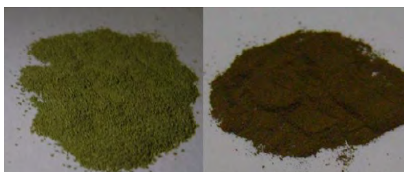
Figura 1. Pigmento de Ferro, calcinada a 900 e 1100°C, respectivamente.
