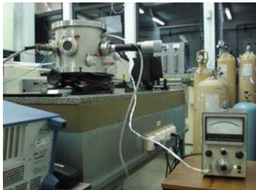
FIGURA 20: Eletrômetro conectado à câmara.
