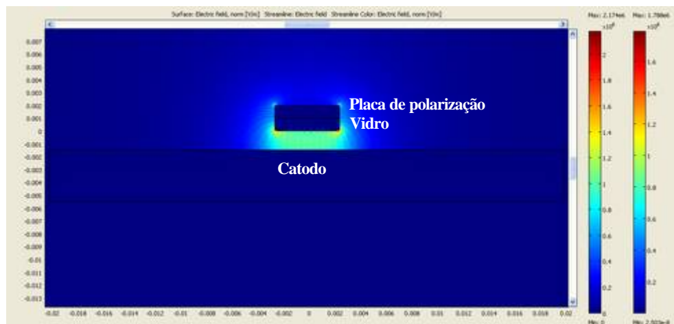
FIGURA 33: Simulação do campo elétrico para a configuração de eletrodos da parte 1 - espaçamento 1,50mm.
