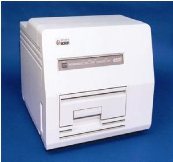
Figura 6. Harshaw modelo 4500, encargado de la lectura de los cristales de TLD (de la pág. Web de Harshaw).
