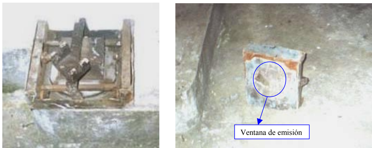
(Fig. 2) Detalle de la fuente radiactiva hallada
