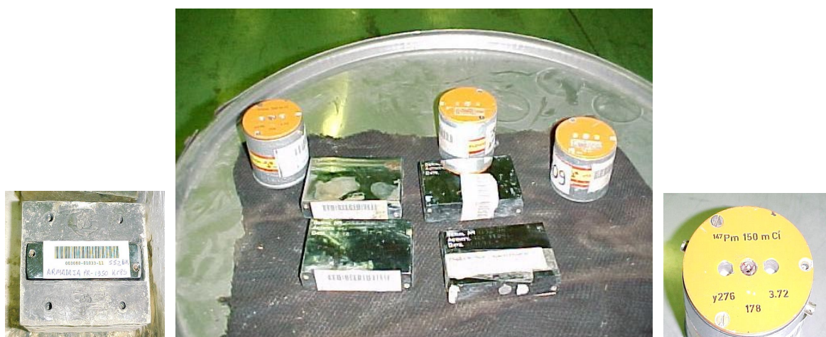
(Fig. 9) Detalle de las fuentes radiactivas recuperadas.
