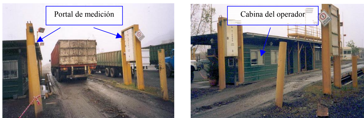
(Fig. 1) Sistema de medición instalado para detectar material radiactivo.
