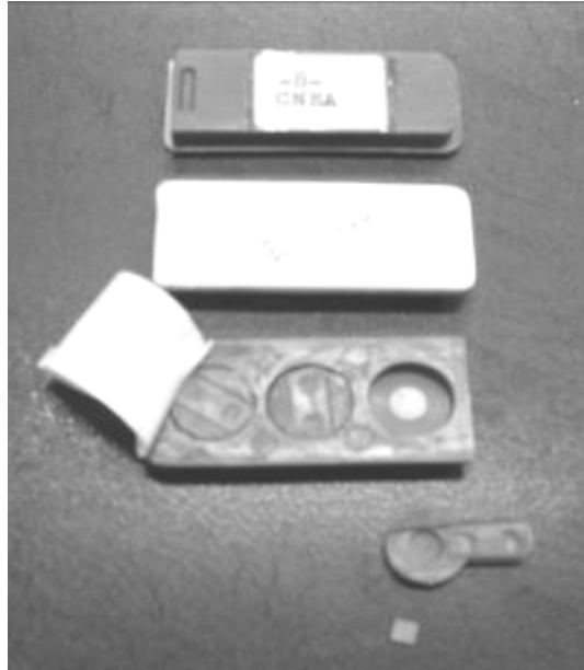
Figura 3. Anverso y reverso de porta TLD's, se observan las cavidades donde se alojan los receptáculos que contienen los detectores. Uno de ellos se muestra en el ángulo inferior derecho.
