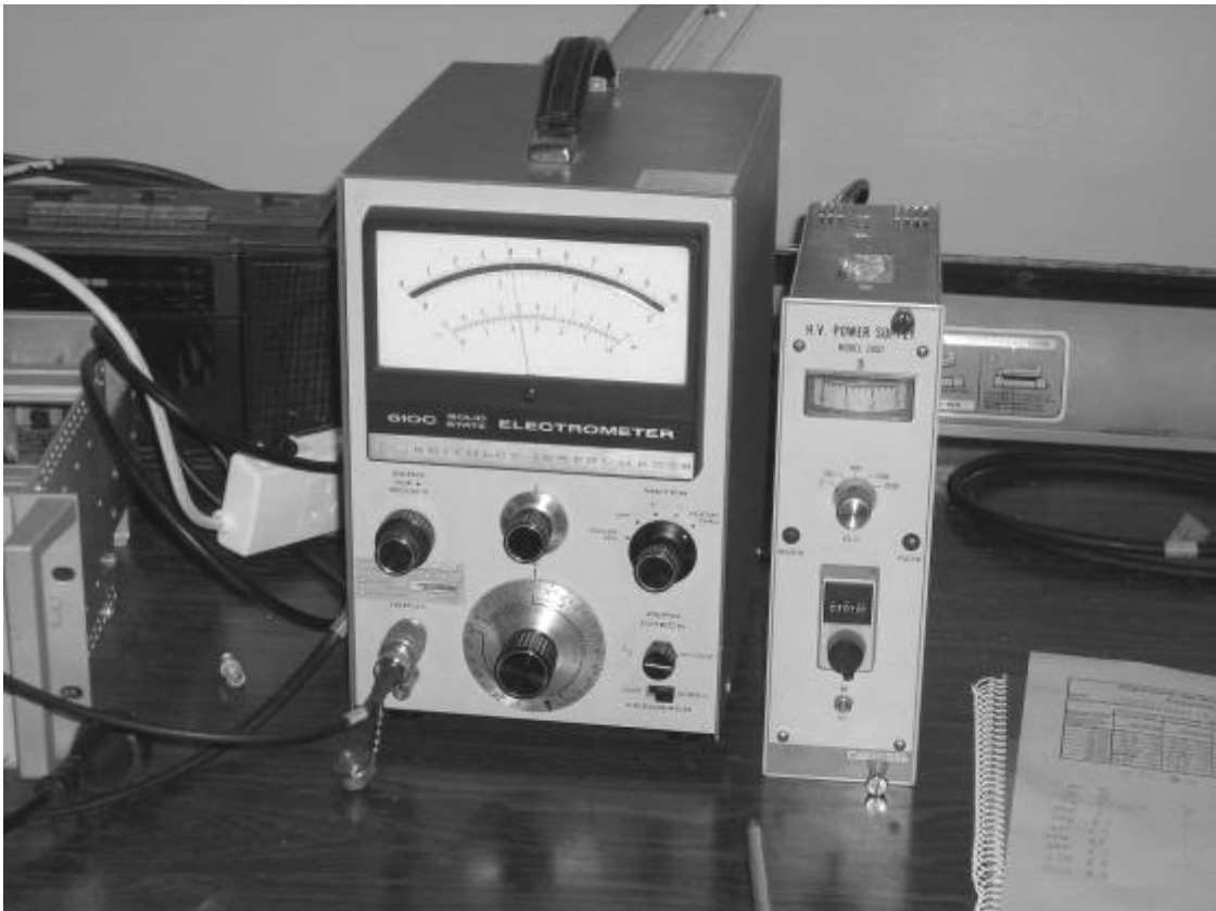
Figura 8. Electrómetro Keithley Instrument modelo 610 C, fuente de alta tensión Camberra
