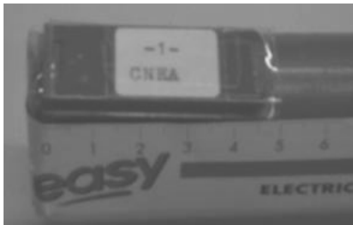
Figura 2c. Detalle de porta-detector dispuesto sobre tubo de PVC
