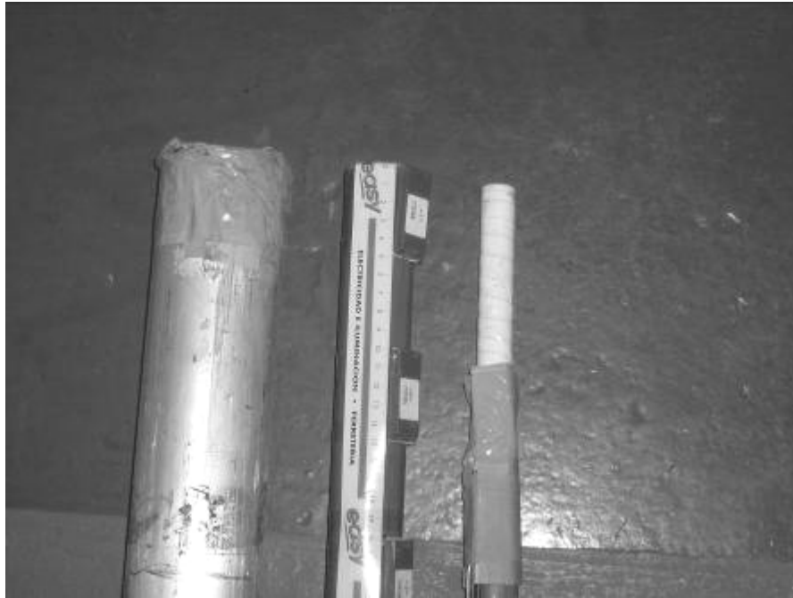
Figura 5. Detalle de los tres dispositivos, Tubo de Al, Caño porta TLD's, y lanza con detector
