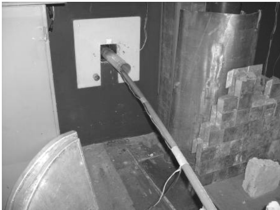
Figura 6. El conjunto formado por el caño de Al, tubo porta TLD's y la lanza con detector, colocados en la instalación
